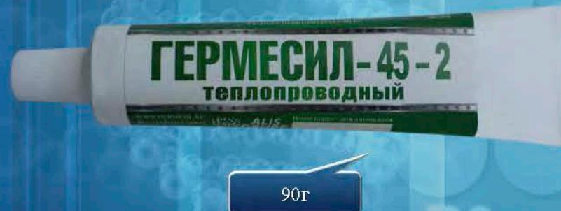
**Сфера применения:** Клей-герметик кремнийорганический "Гермесил-45-2 теплопроводный" представляющий собой пастообразный продукт на основе низкомолекулярного каучука с добавлением наполнителя. Обладает повышенной теплопроводностью 1,8 Вт/(м\*К). Предназначен для отвода тепла от греющихся элементов.
